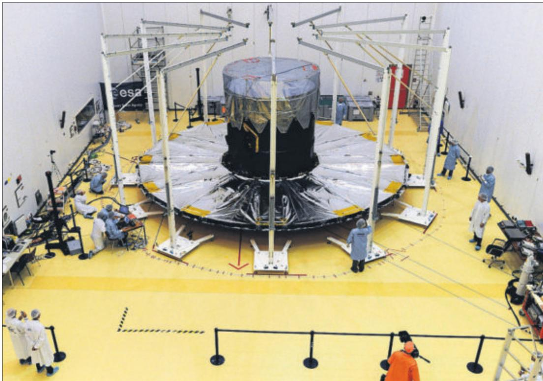
Último ensayo de despliegue del gran parasol del telescopio Gaia, en la base espacial de Kourou, en Guyana francesa, antes del lanzamiento. /ESA
